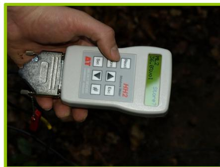
Fig. 38. Mesure de la teneur en eau volumétrique à l'aide d'une sonde Thétaprobe [15].
