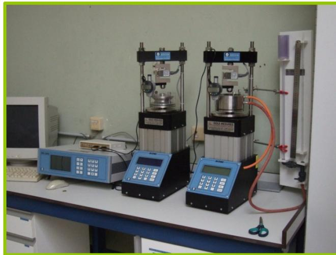
Fig. 25. Oedomètres automatiques.
