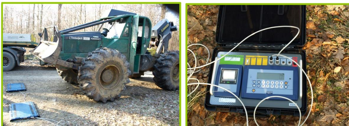
Fig. 36. Mesure de la charge sous l'essieu par plaques dynamométriques [15].
