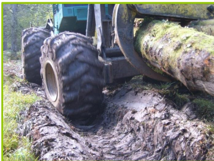
Fig. 20. Ornière créée par le passage d'une débusqueuse à pince dans un sol hydromorphe.
