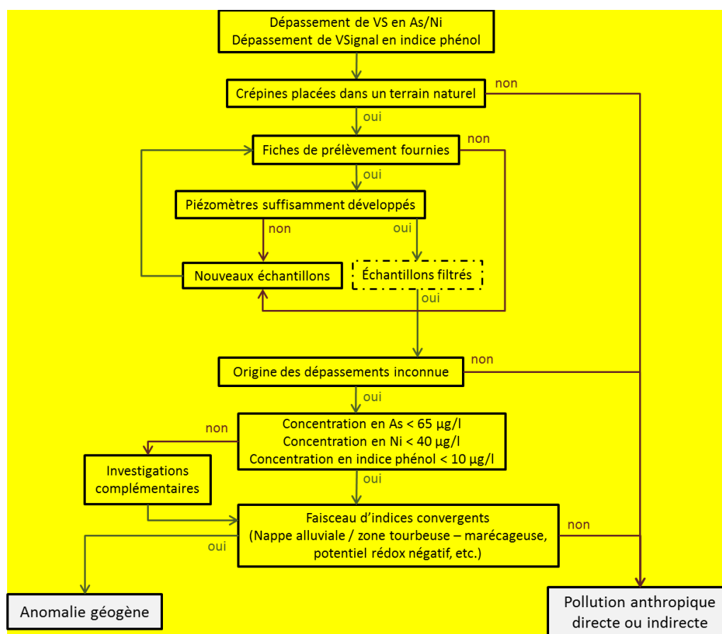
Figure 5 : schéma décisionnel pour mettre en évidence une anomalie géogène dans l'eau souterraine ; la case en pointillé concerne uniquement les anomalies en métaux.
