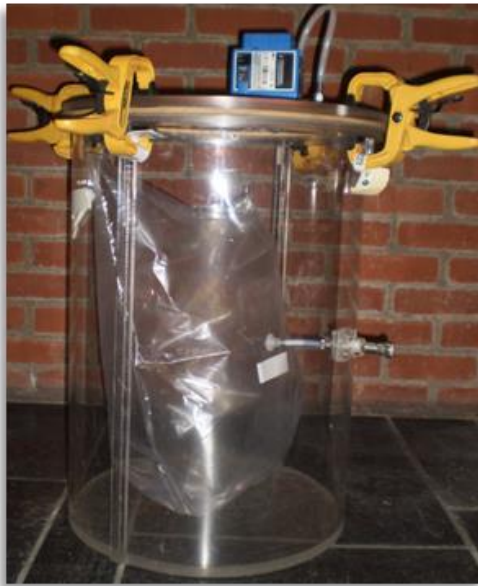
Figure 2. Sac de prélèvement placé dans une cuve hermétique, permettant le prélèvement d'air grâce à une mise en dépression de la cuve (ISSeP, 2024).
