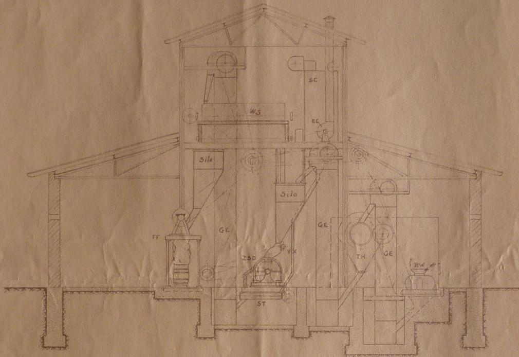
Projet d'installation de broyage, de séchage et de bariillage
