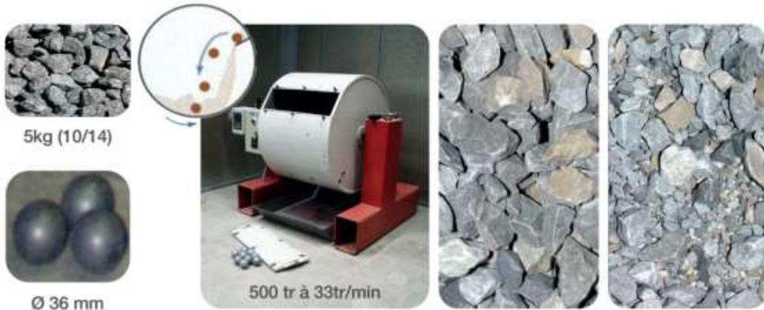
Principe de l'essai Los Angeles et comparaison d'un échantillon de granulat avant et après réalisation de l'essai (Source : CRR).
