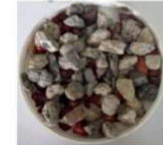
30 % maçonnerie - 70 % béton
