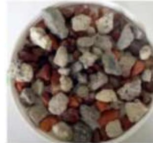
50 % maçonnerie - 50 % béton
