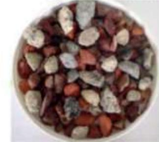
70 % maçonnerie - 30 % béton
