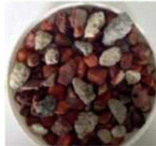
80 % maçonnerie - 20 % béton
