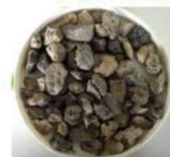
0 % maçonnerie - 100 % béton
