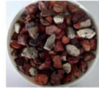
90 % maçonnerie - 10 % béton
