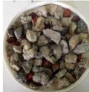
10 % maçonnerie - 90 % béton
